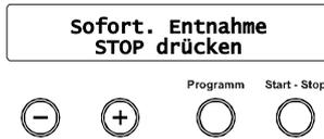
In der Trocknungsphase wird die abgelaufene Trocknungszeit im Wechsel mit der Meldung **Sofort. Entnahme „Stop“ drücken** angezeigt.
