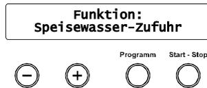
1. Wählen Sie das Menü **Funktion** durch gleichzeitiges kurzes Drücken der TASTEN (+) und (-). Das Display zeigt **Funktion: Letzte Chargennr.**
