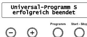
Am Ende eines Programms wird der Kesseldruck dem Umgebungsdruck angeglichen. Wenn das Programm erfolgreich beendet wurde, erscheint eine entsprechende Mitteilung auf dem Display.
